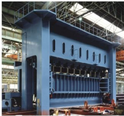
50MN プレス MP-75 4連 5000kN シリンダ 10台使用
